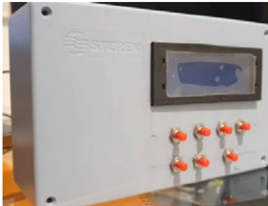
Figura 10. Implementación física del generador de pulsos.
