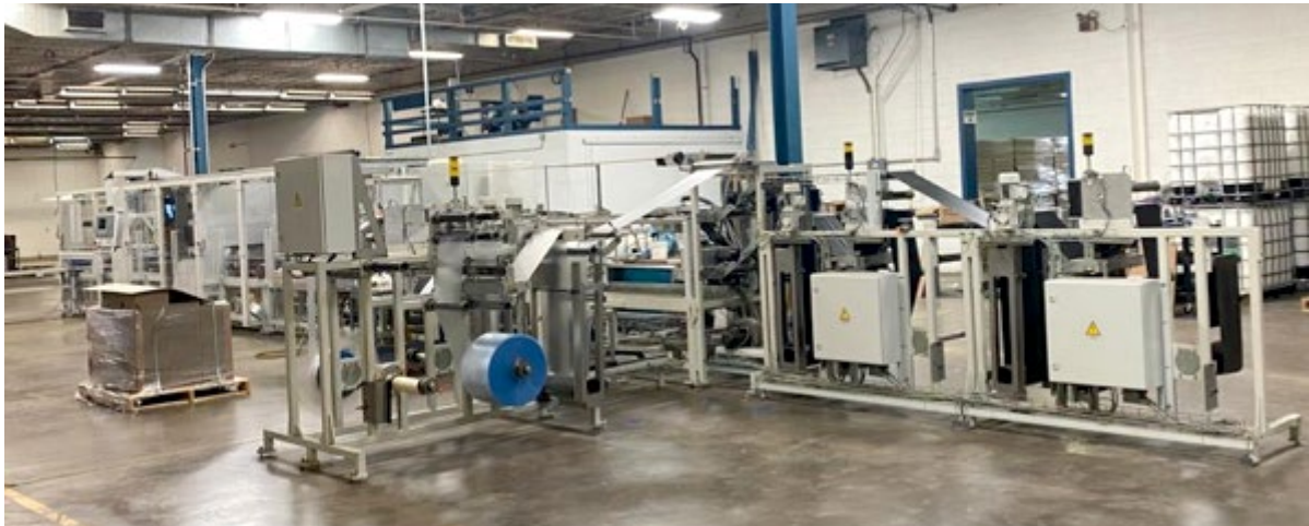
Máquina Widmann para encuadernación de carpetas con sellado ultrasónico. Fotografía cortesía de Gabriel Rihan de SAMSILL de Mexico, S.A. de C.V.
