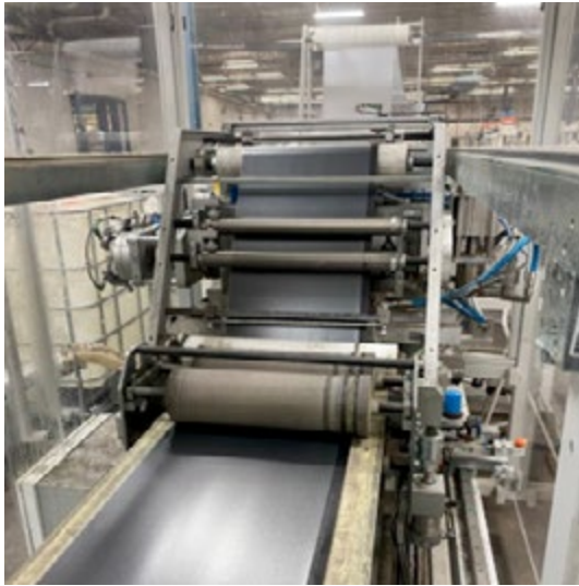
Figura 2. Fijación de película del PP al cartón. Fotografía cortesía de Gabriel Rihan de SAMSILL de Mexico S.A de C.V.
