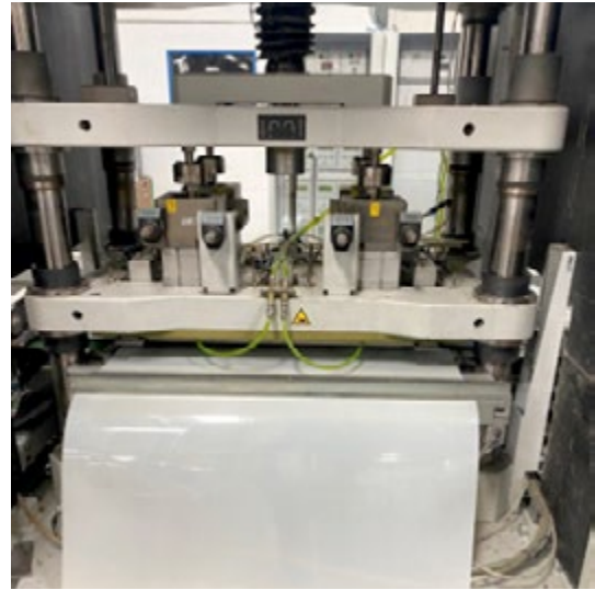
Figura 3. Selladora con fuentes de enfriamiento. Fotografía cortesía de Gabriel Rihan de SAMSILL de Mexico, S.A. de C.V.
