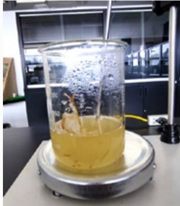
Figura 2. Despigmentación de las fibras con la solución de hipoclorito de sodio. Foto: Jorge Alberto Granados Olvera, 2023.
