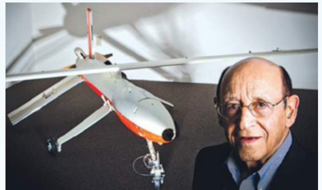
Figura 4. Prototipo UAV de Abraham Karem, llamado Albatross que sirvió de base para desarrollar el Predator, uno de los UAV de mayor éxito en la historia de Estados Unidos. Imagen tomada https://www.google.com/url?sa=i&url=https%3A%2F%2Fwww.uasvision.com%2F2017%2F04%2F07%2Fas-the-predator-retires-its-inventor-remembers-its-birth%2F&psig=AOvVaw3l-MDSoiC39y5laUnPb-&ust=1734715416128000&source=images&cd=vfe&opi=89978449&ved=0CBQQjRqFwoTCKDrytqstloDFQAAAAAdAAABAE
